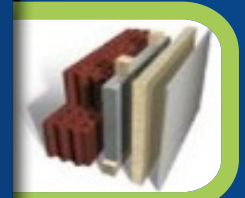
Mauerwerk mit Trägersystem
